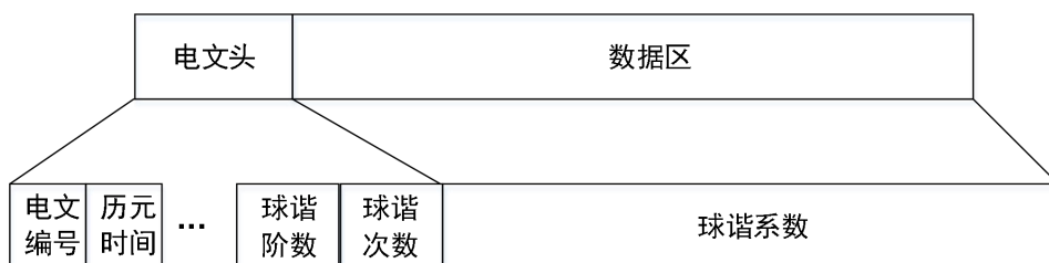
图 5-3 电离层球谐电文编排示意图
